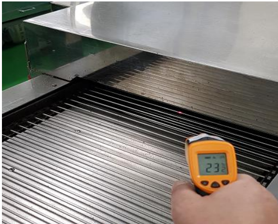
구이기 내부 온도 측정
